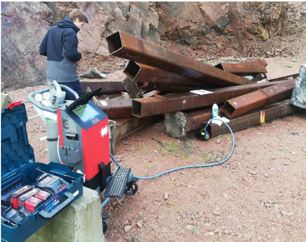
Figur C.4 Analys av kemisk sammansättning med OES spektrometer, Mantena AS
