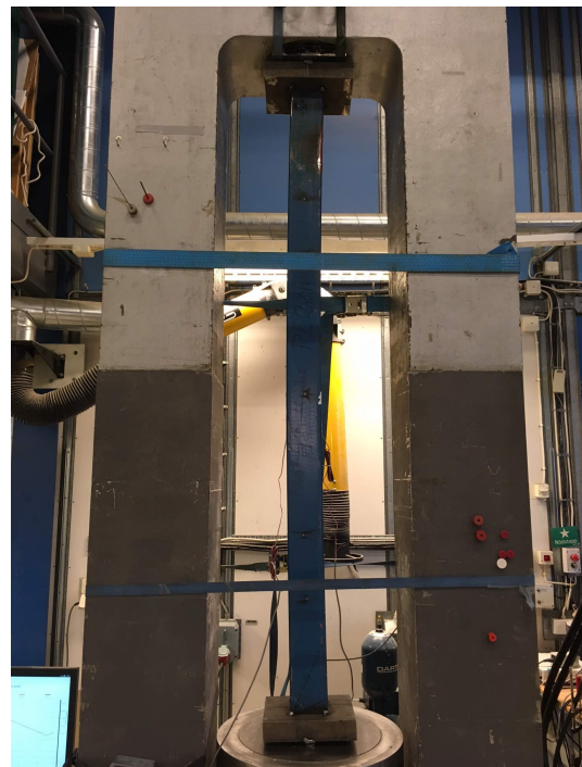
Figur 1.1 Pelare av fyrkantrör som provbelastas på grund av osäkerheter om stålsort
